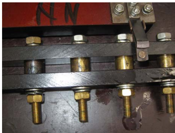
SLIKA 2 – Fotografije nekoliko oštećenih nepokretnih kontakata besteretnog menjača
