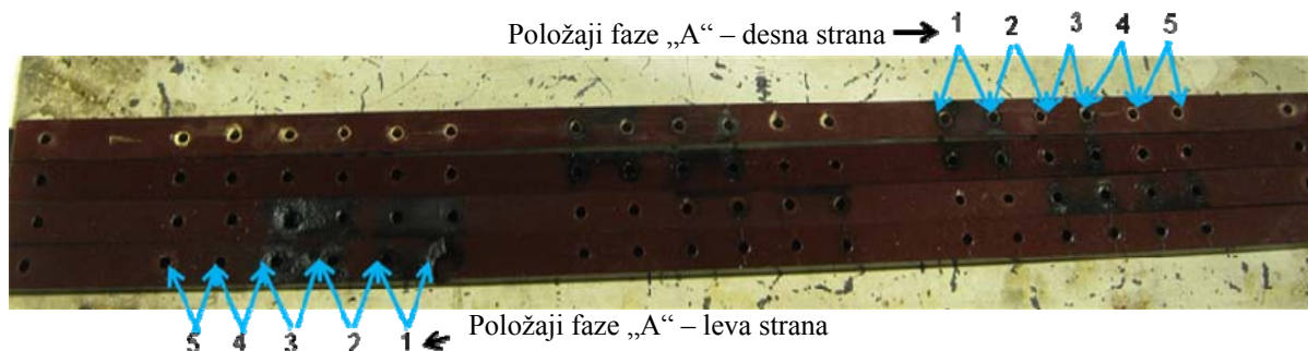
SLIKA 4 – Fotografija nosača nepokretnih kontakata (letve)
