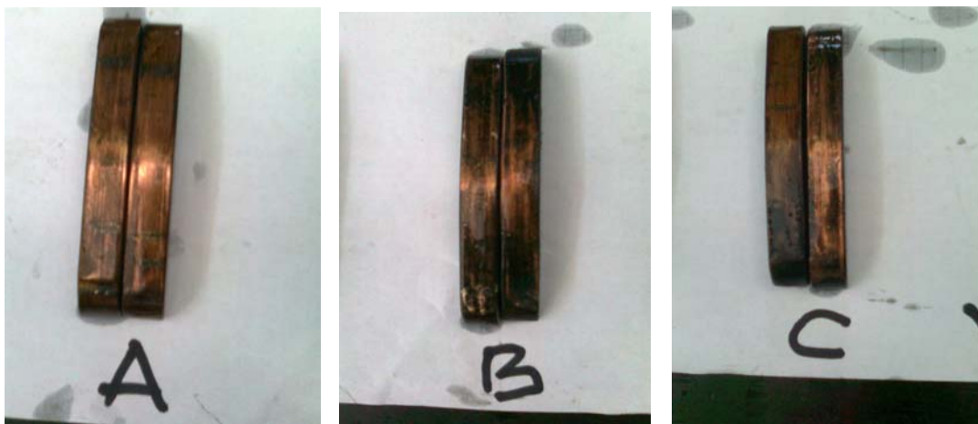
SLIKA 3 – Fotografije nekoliko oštećenih pokretnih kontakata besteretnog menjača
